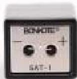
こて先センサーユニットの検出端を + - の極性を確認してMCA - 900 に接続します。
